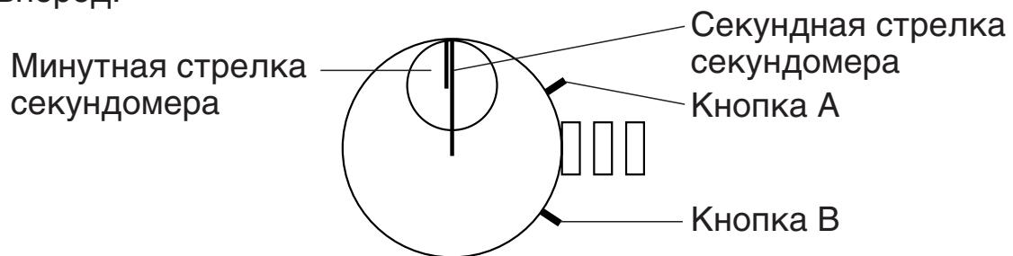
Впоследствии, если Вы продолжаете нажимать Кнопку А в течение приблизительно 2 секунд, секундная стрелка секундомера сделает один круг.
